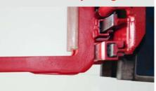
Sie können Ihr neues Anbaugerät bereits bei uns präventiv mit 8 mm Hardoxverschleißblechen im Gabelknick bestellen. Sollten diese abgenutzt sein, können diese schnell und einfach an der Gabelzinke durch Anheftung mit Schweißpunkten in Längsrichtung ersetzt werden. Die Verschleißbleche sind vorne und hinten angeschrägt damit keine Störkante an der Gabel entstehen kann.
