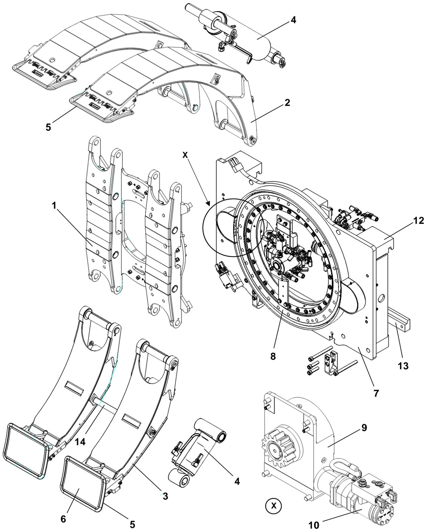
Die Klammer besteht aus einem Klammerkörper (1), zwei oberen (langen) Armen (2) und zwei unteren (kurzen) Armen (3), die mit Hydraulikzylindern (4) verstellt werden. Die oberen (langen) Arme (2) und die unteren (kurzen) Arm (3) haben geteilte Druckplatten (5). Die unteren (kurzen) Arme (3) sind durch einen Bolzen (14) verbunden.
