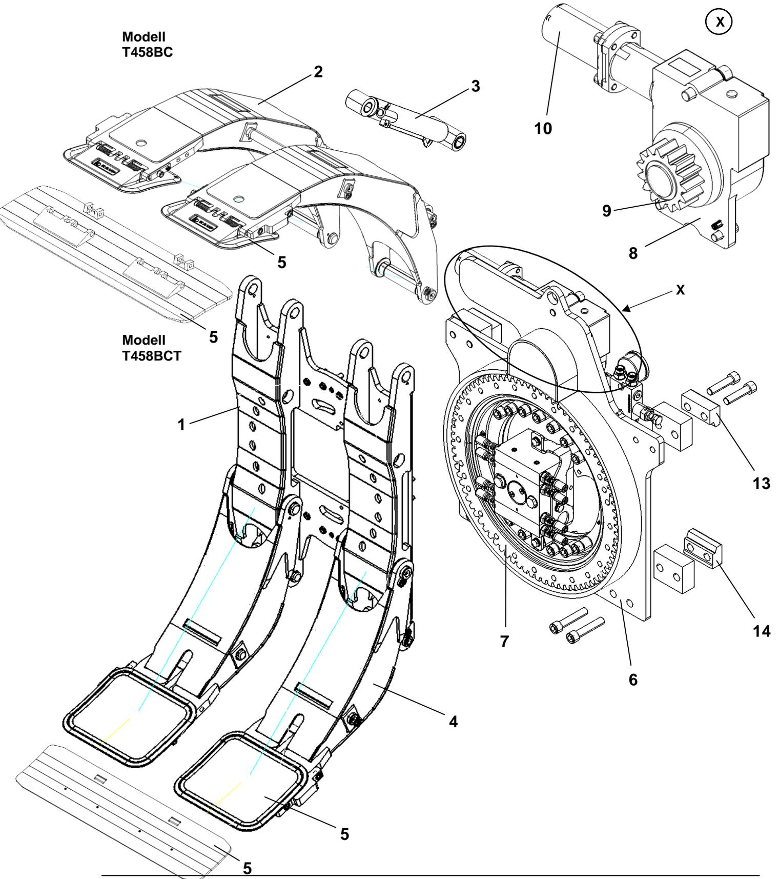
Die Klammer besteht aus einem Klammernkörper (1) mit zwei oberen (langen) Armen (2), die mit Hydraulikzylinder (3) verstellt werden, und zwei unteren (kurzen) starren Armen (4).
