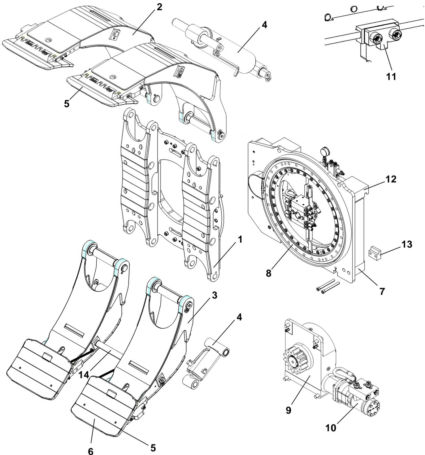
Die Klammer besteht aus einem Klammerkörper (1), zwei oberen (langen) Armen (2) und zwei unteren (kurzen) Armen (3), die mit Hydraulikzylindern (4) verstellt werden. Die oberen (langen) Arme (2) und die unteren (kurzen) Arm (3) haben geteilte Druckplatten (5). Die unteren (kurzen) Arme (3) sind durch einen Bolzen (14) verbunden.
