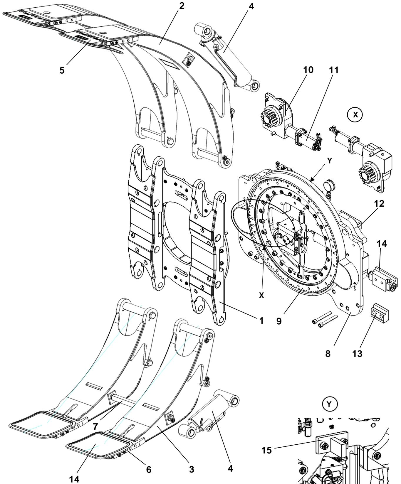
Die Klammer besteht aus einem Klammerkörper (1), oberen (langen) Armen (2) und unteren (kurzen) Armen (3), die mit Hydraulikzylindern (4) verstellt werden. Die oberen (langen) Arme (2) und die unteren (kurzen) Arme (3) haben geteilte Druckplatten (5, 6). Die unteren (kurzen) Arme (3) und oberen (langen) Arme (2) sind jeweils durch einen Bolzen (7) verbunden. Unterschiedliche Beläge (14) sind passend zur transportierenden Last verfügbar.
