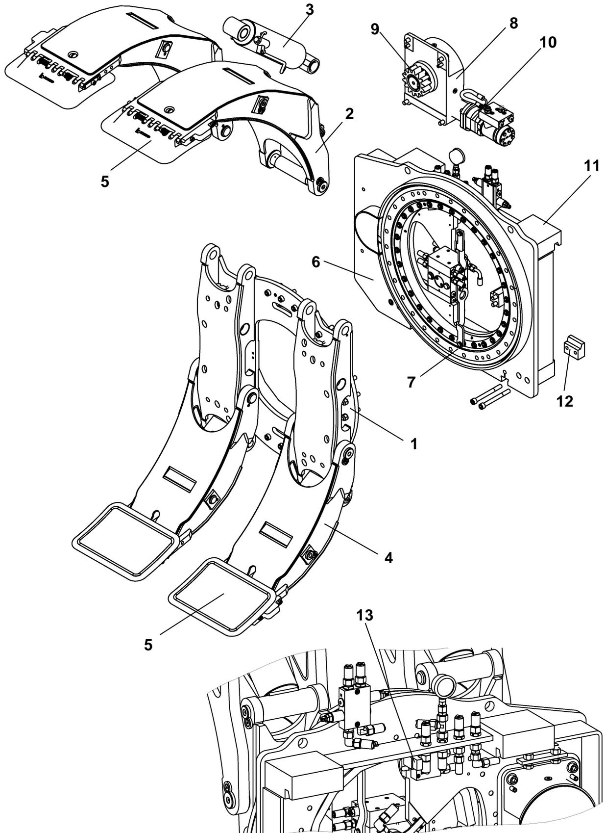
Die Klammer besteht aus einem Klammerkörper (1) mit zwei oberen (langen) Armen (2), die mit Hydraulikzylinder (3) verstellt werden, und zwei unteren (kurzen) starren Armen (4). Die Arme (2 und 4) haben geteilte Druckplatten (5).
