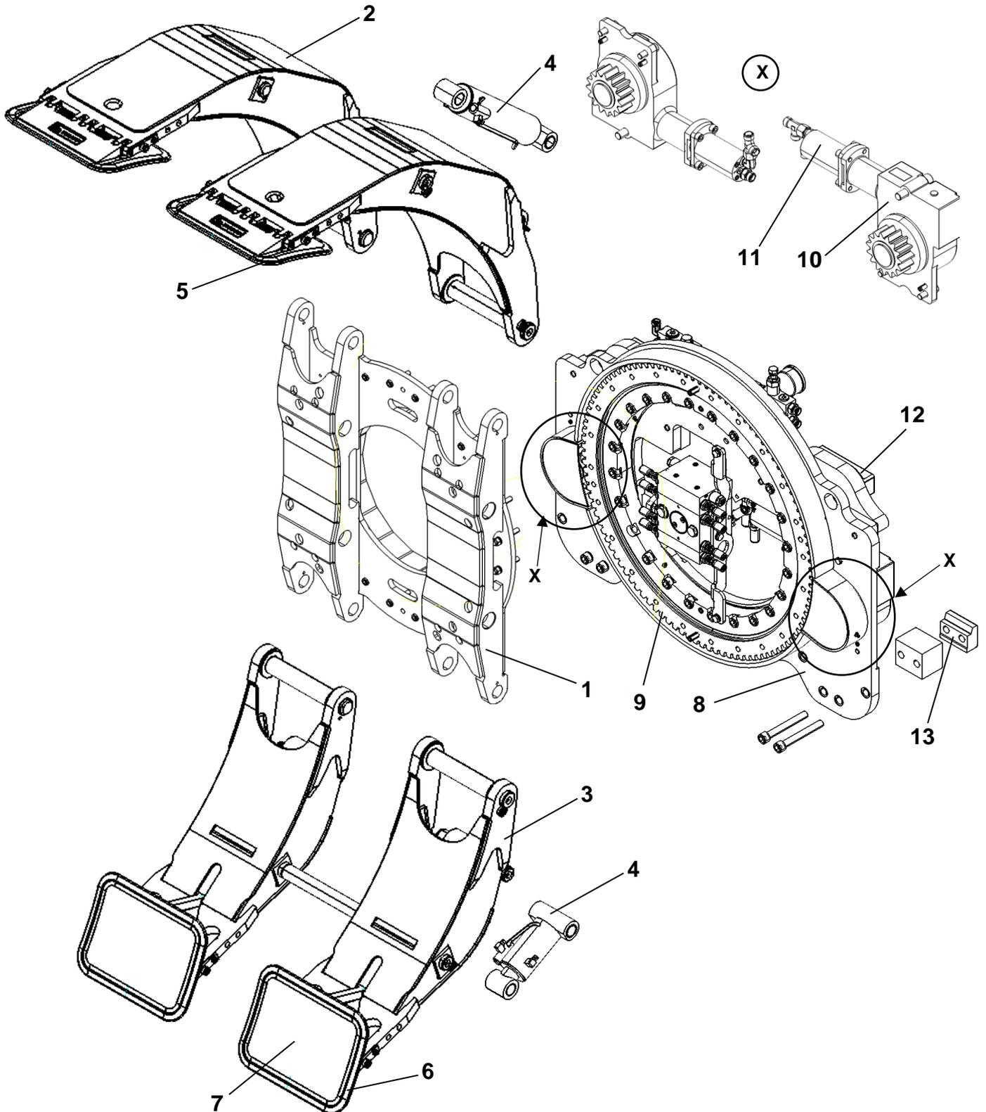
Die Klammer besteht aus einem Klammerkörper (1), zwei oberen (langen) Armen (2) und zwei unteren (kurzen) Armen (3), die mit Hydraulikzylindern (4) verstellt werden. Die Arme (2, 3) haben geteilte Druckplatten (5, 6).
