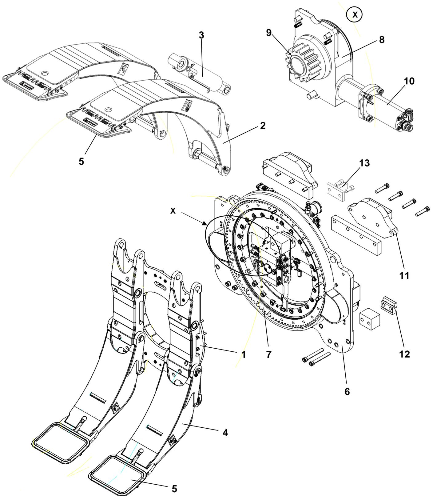
Die Klammer besteht aus einem Klammerkörper (1) mit zwei oberen (langen) Armen (2), die mit Hydraulikzylinder (3) verstellt werden, und zwei unteren (kurzen) starren Armen (4). Die Arme (2 und 4) haben geteilte Druckplatten (5).
