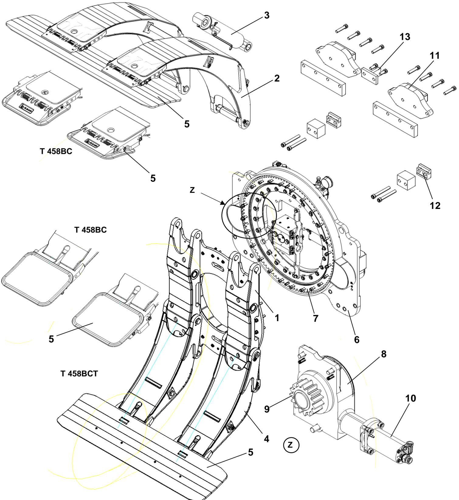
Die Klammer besteht aus einem Klammerkörper (1) mit zwei oberen (langen) Armen (2), die mit Hydraulikzylinder (3) verstellt werden, und zwei unteren (kurzen) starren Armen (4). Die Arme (2 und 4) haben eine durchgehende Druckplatte (5).
