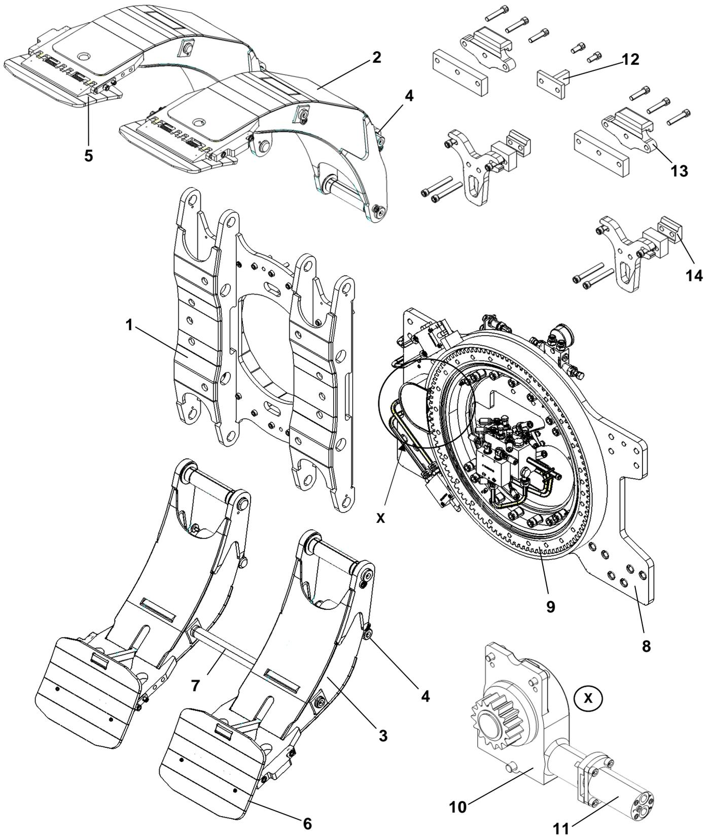
Die Klammer besteht aus einem Klammerkörper (1), oberen (langen) Armen (2) und unteren (kurzen) Armen (3), die mit Hydraulikzylindern (4) verstellt werden. Die oberen (langen) Arme (2) und die unteren (kurzen) Arme (3) haben geteilte Druckplatten (5, 6). Die unteren (kurzen) Arme (3) sind durch einen Bolzen (7) verbunden.
