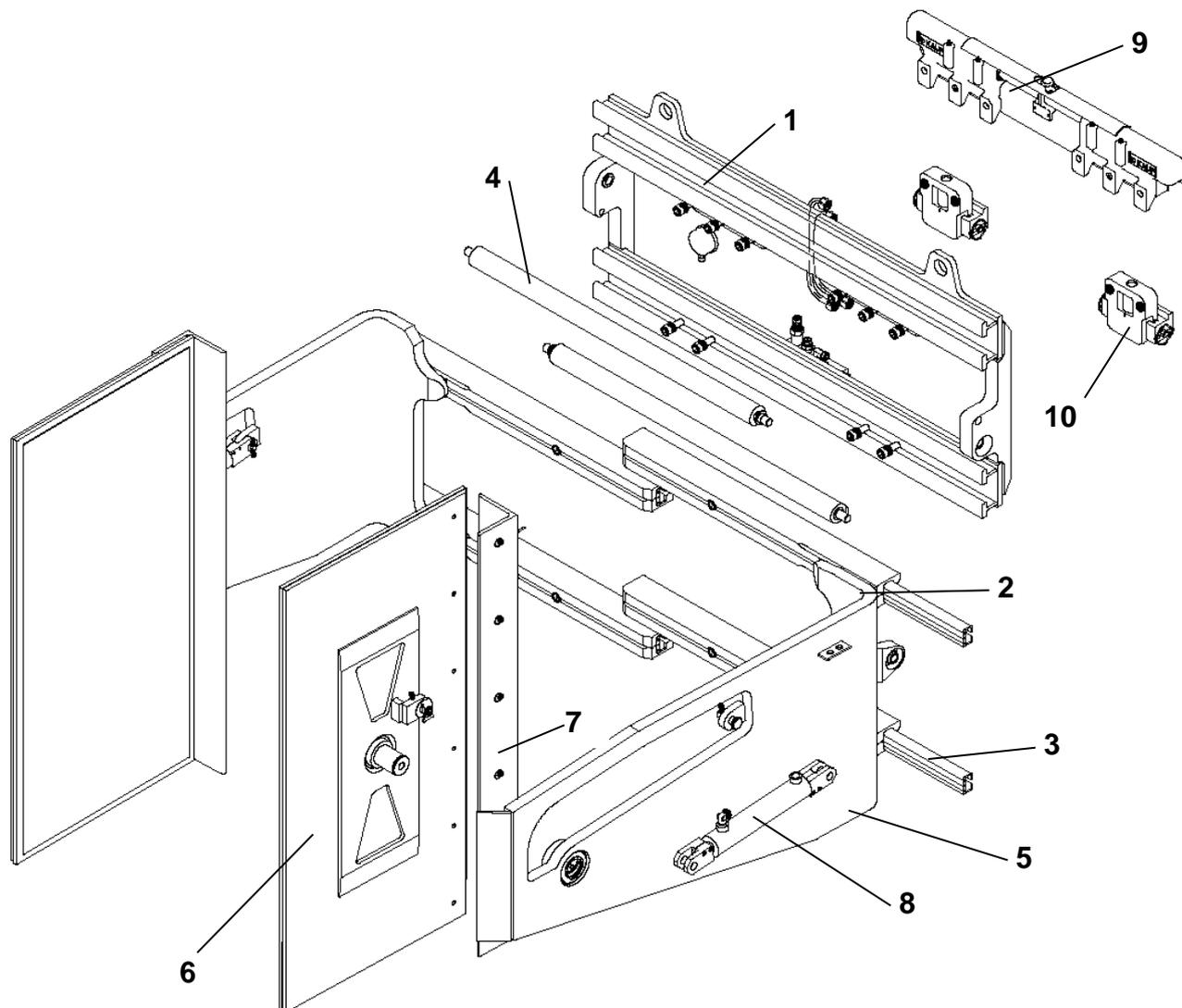
Die Geräteklammer T413G-2H besteht aus einem Klammerkörper (1), auf dem Schlitten (2) montiert sind. Zylinder (4) verschieben die mit Gleitstücken (3) ausgerüsteten Schlitten (2). An die Schlitten (2) sind Klammerarme (5) angeschweißt. An den Armen (5) sind Druckplatten (6) mit angeschraubten Winkeln (7) befestigt. Die Druckplatten können über Zylinder (8) um 90° gedreht werden. Am Klammerkörper (1) sind Seitenschubkomponenten (9, 10) angebaut.
