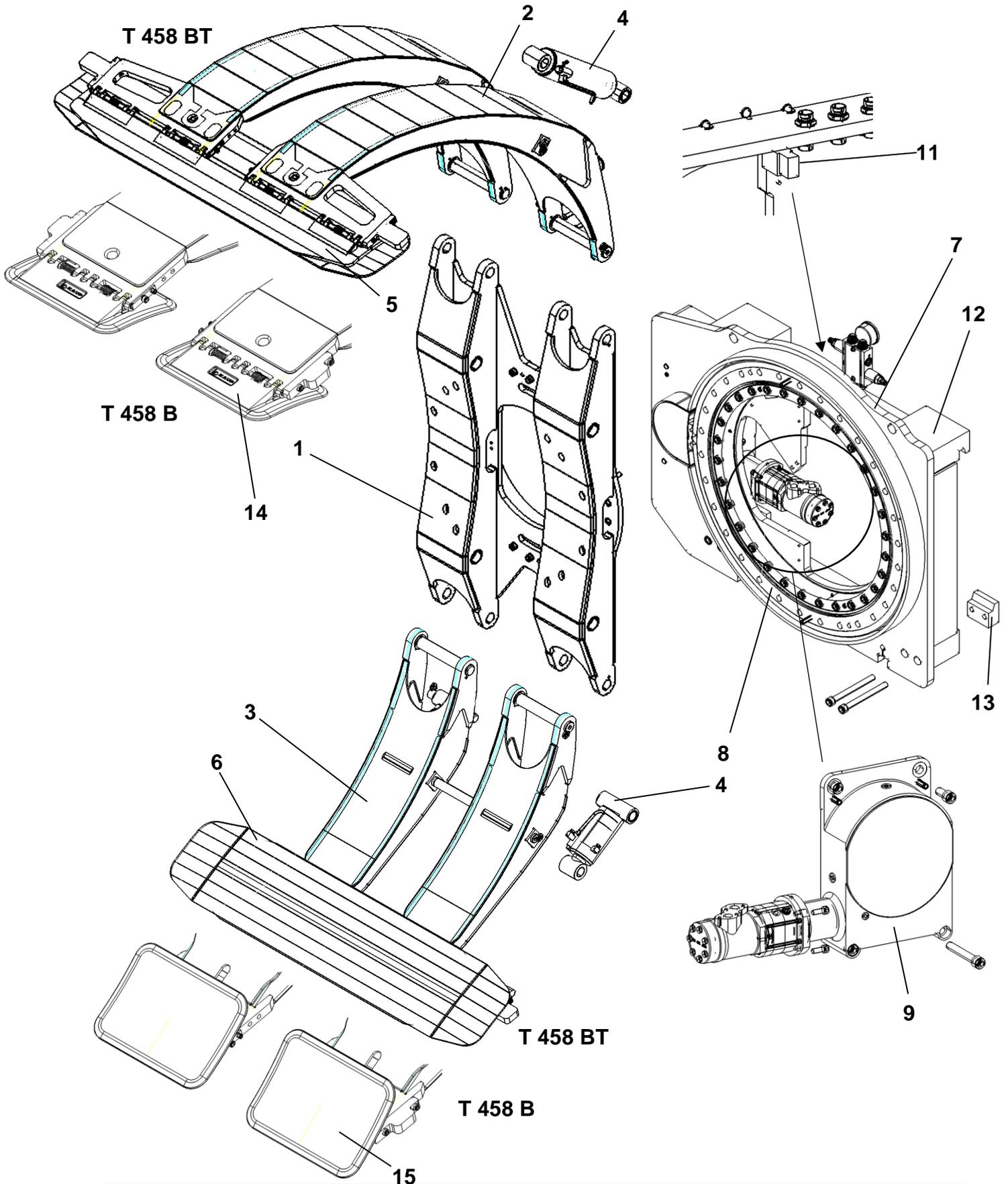
Die Klammer besteht aus einem Klammerkörper (1), einem oberen (langen) Arm (2) und einem unteren (kurzen) Arm (3), die mit Hydraulikzylindern (4) verstellt werden.
