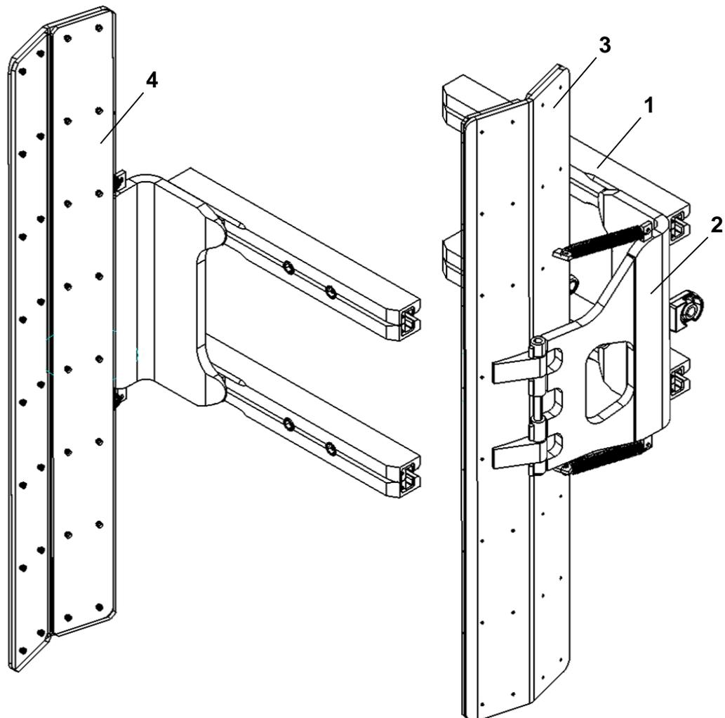
Die Schlitten bestehen aus einem Profil (1), an das ein Arm (2) angeschweißt ist. Eine Druckplatte (3) ist im Arm (2) pendelnd gelagert.
