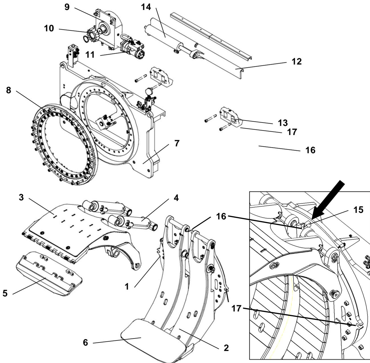
Die Klammer besteht aus einem Klammerkörper (1) mit einem starren unteren Arm (2) und einem beweglichen oberen Arm (3), der mit Hydraulikzylindern (4) verstellt wird. Die Arme haben eine durchgehende Druckplatte (5). Die Druckplatten sind mit Riffelblech(6) belegt.
