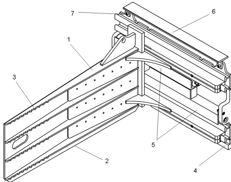
Recyclingklammerarme bestehen aus einem Armprofil (1) mit einer Zahnleiste (3) und einer Verschleißleiste (2). Der Klammerkörper besitzt eine untere Verschleißleiste (4), einen Zylinderschutz (5) und einen Schlauchschutz (6), der mit Schrauben (7) am Klammerkörper angeschraubt ist.
