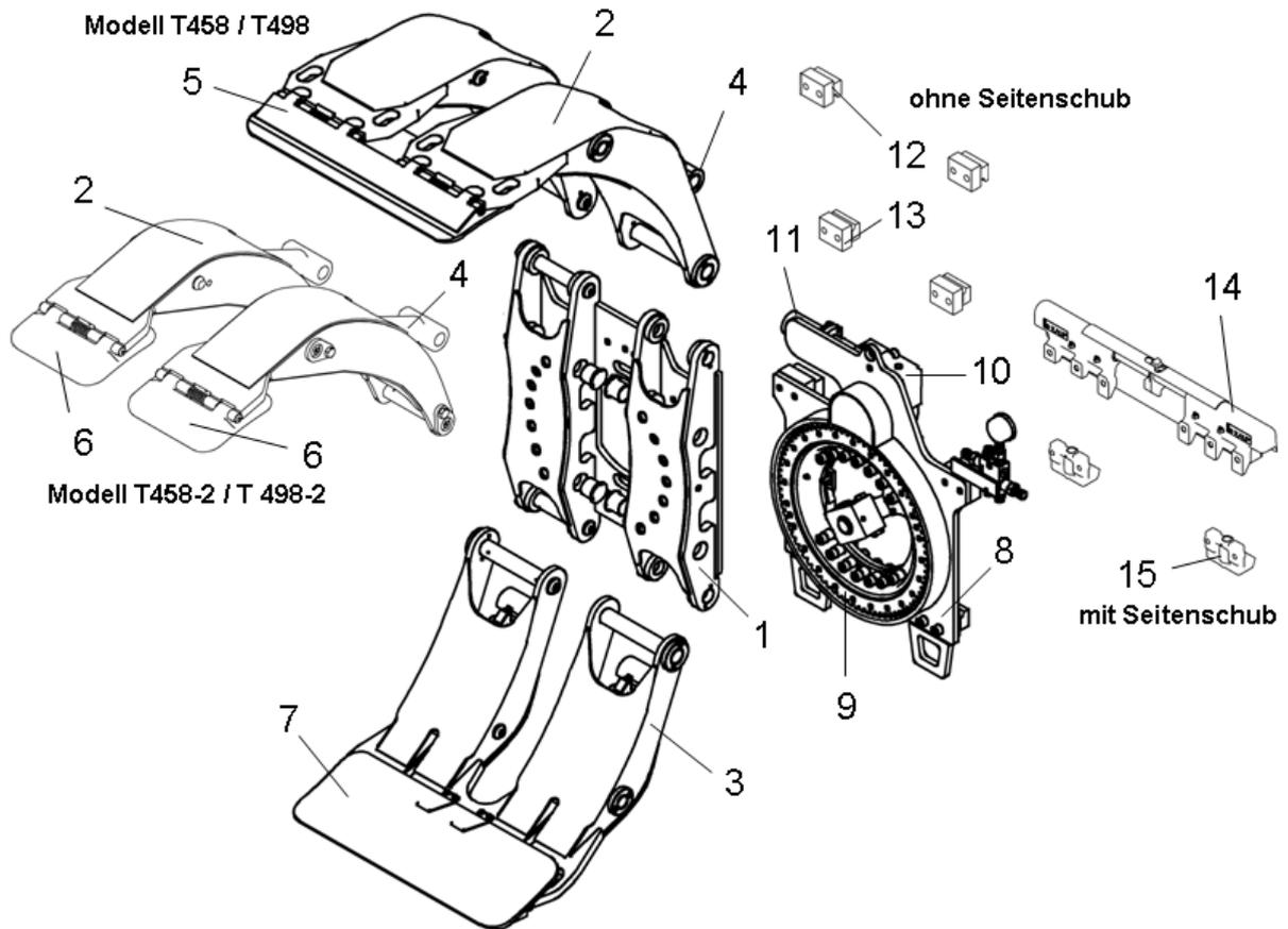
Die Klammer besteht aus einem Klammerkörper (1), einem oberen Arm (2) und einem unteren Arm (3), die mit Hydraulikzylindern (4) verstellt werden. Der obere Arm (2) hat eine durchgehende Druckplatte (5) bei Modell T458/T498 oder geteilte Druckplatten (6) bei Modell T458-2 / T498-2. Unterschiedliche Beläge (7) sind passend zur transportierenden Last verfügbar.
