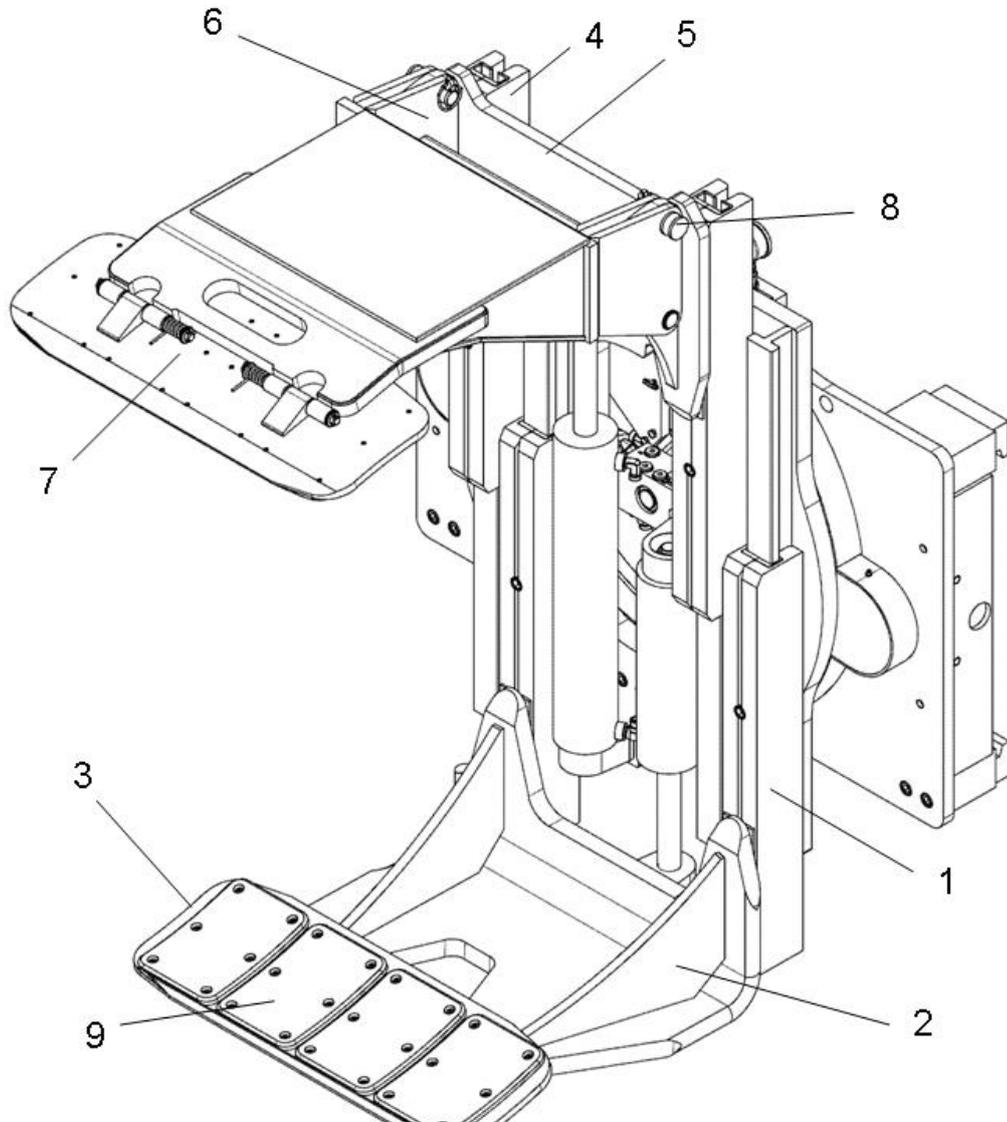
Der untere Schlitten besteht aus einem Profil (1), an das ein Arm (2) angeschweißt ist. Eine Druckplatte (3) ist im Arm (2) pendelnd gelagert.
