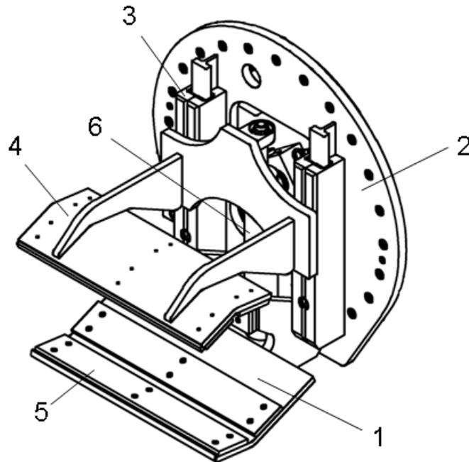
Der untere Arm besteht aus einer festen Druckplatte (1), die am Klammerkörper (2) angeschweißt ist.
