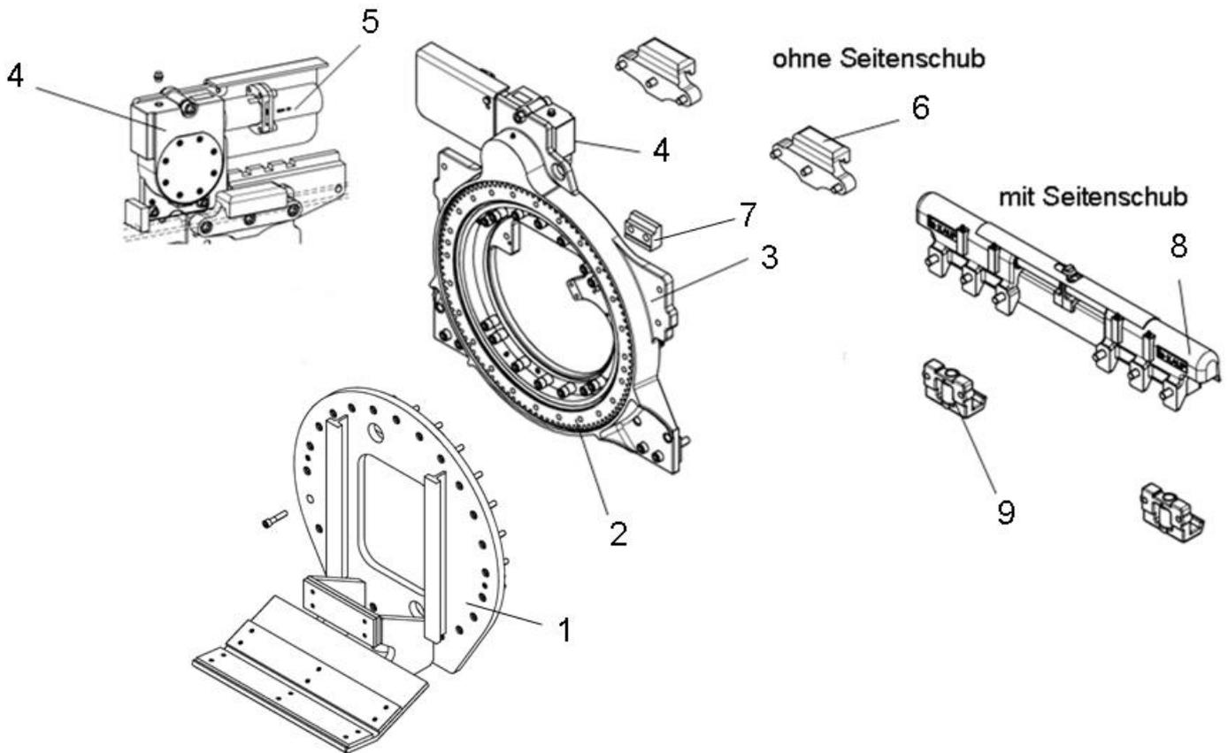
Eine drehbare Klammer besteht aus einem Klammerkörper (1), der mit einer Kugeldrehverbindung (2) verschraubt ist. An der Grundplatte (3) ist ein Antrieb (4), bestehend aus Ritzel, Getriebe und Ölmotor (5) angebaut.
