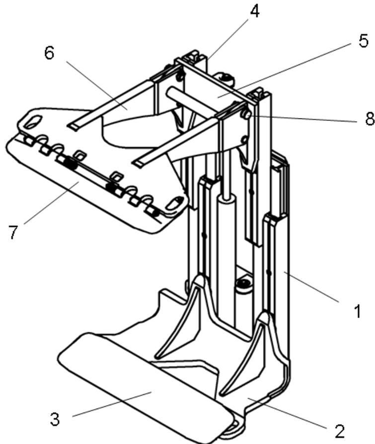
Der untere Schlitten besteht aus einem Profil (1), an das ein Arm (2) angeschweißt ist. Eine Druckplatte (3) ist im Arm (2) pendelnd gelagert.
