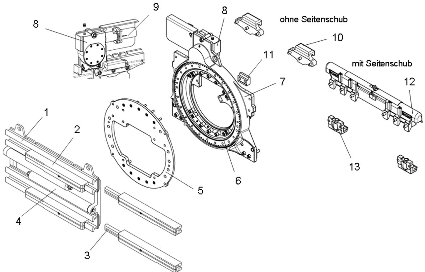
Eine drehbare Klammer besteht aus einem Klammerkörper (1), auf dem Führungsprofile (2) montiert sind. Zylinder (4) verschieben die mit Gleitstücken (3) ausgerüsteten Führungsprofile (2). Der Klammerkörper (1) wird an einen Flansch (5) montiert, der mit einer Kugeldrehverbindung (6) verschraubt ist. An der Grundplatte (7) ist ein Antrieb (8), bestehend aus Ritzel, Getriebe und Ölmotor (9) angebaut.
