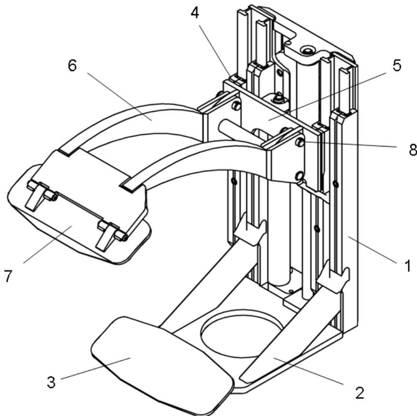
Der untere Schlitten besteht aus einem Profil (1), an das ein Arm (2) angeschweißt ist. Eine Druckplatte (3) ist im Arm (2) pendelnd gelagert.
