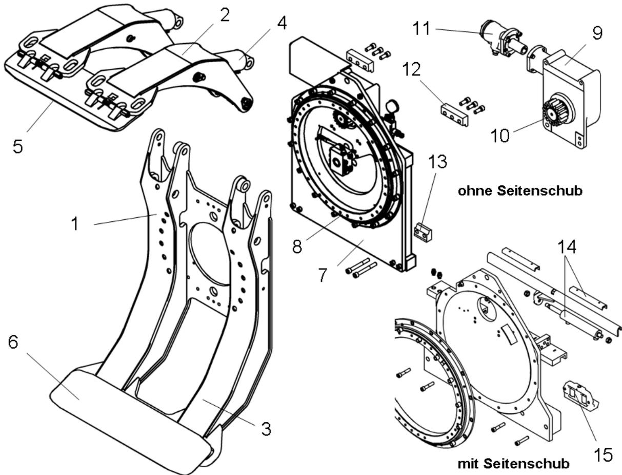
Die Klammer besteht aus einem Klammerkörper (1) und starrem unterem Arm (3). Der obere Arm (2) wird mit Hydraulikzylindern (4) verstellt. Der obere Arm (2) hat eine durchgehende Druckplatte (5) bei Modell T458C/T498C oder eine geteilte Druckplatte bei Modell T458C-2 / T498C-2.
