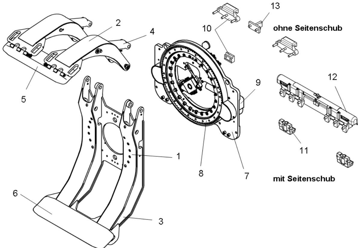
Die Klammer besteht aus einem Klammerkörper (1) und starrem unterem Arm (3). Der obere Arm (2) wird mit Hydraulikzylindern (4) verstellt. Der obere Arm (2) hat eine durchgehende Druckplatte (5) bei Modell T458C/T498C oder eine geteilte Druckplatte bei Modell T458C-2 / T498C-2.
