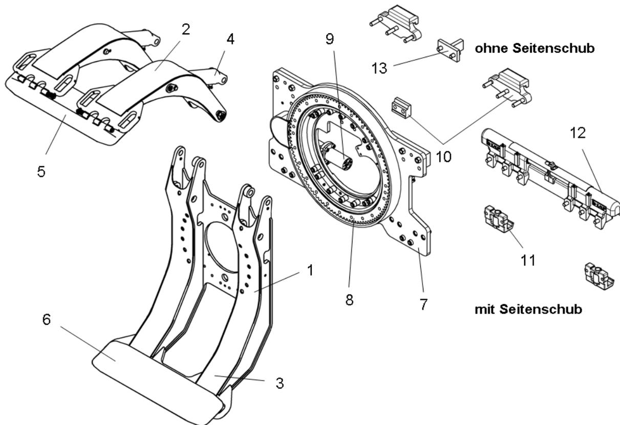
Die Klammer besteht aus einem Klammerkörper (1) und starrem unteren Arm (3). Der obere Arm (2) wird mit Hydraulikzylindern (4) verstellt. Der obere Arm (2) hat eine durchgehende Druckplatte (5), bei Modell T458C/T498C, oder eine geteilte Druckplatte, bei Modell T458C-2/T498C-2.
