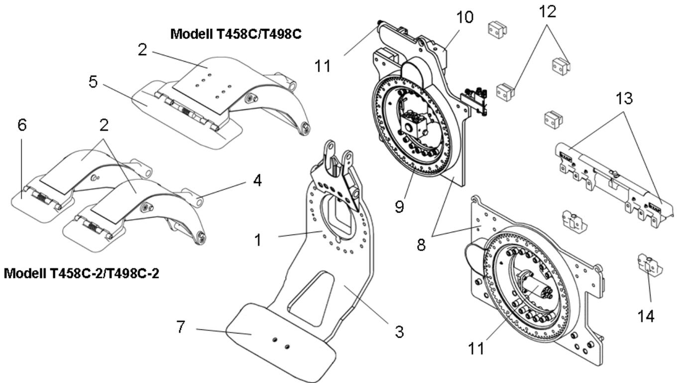
Die Klammer besteht aus einer Kombination aus Klammerkörper (1) und starrem unteren Arm (3). Der obere Arm (2) wird mit Hydraulikzylindern (4) verstellt.
