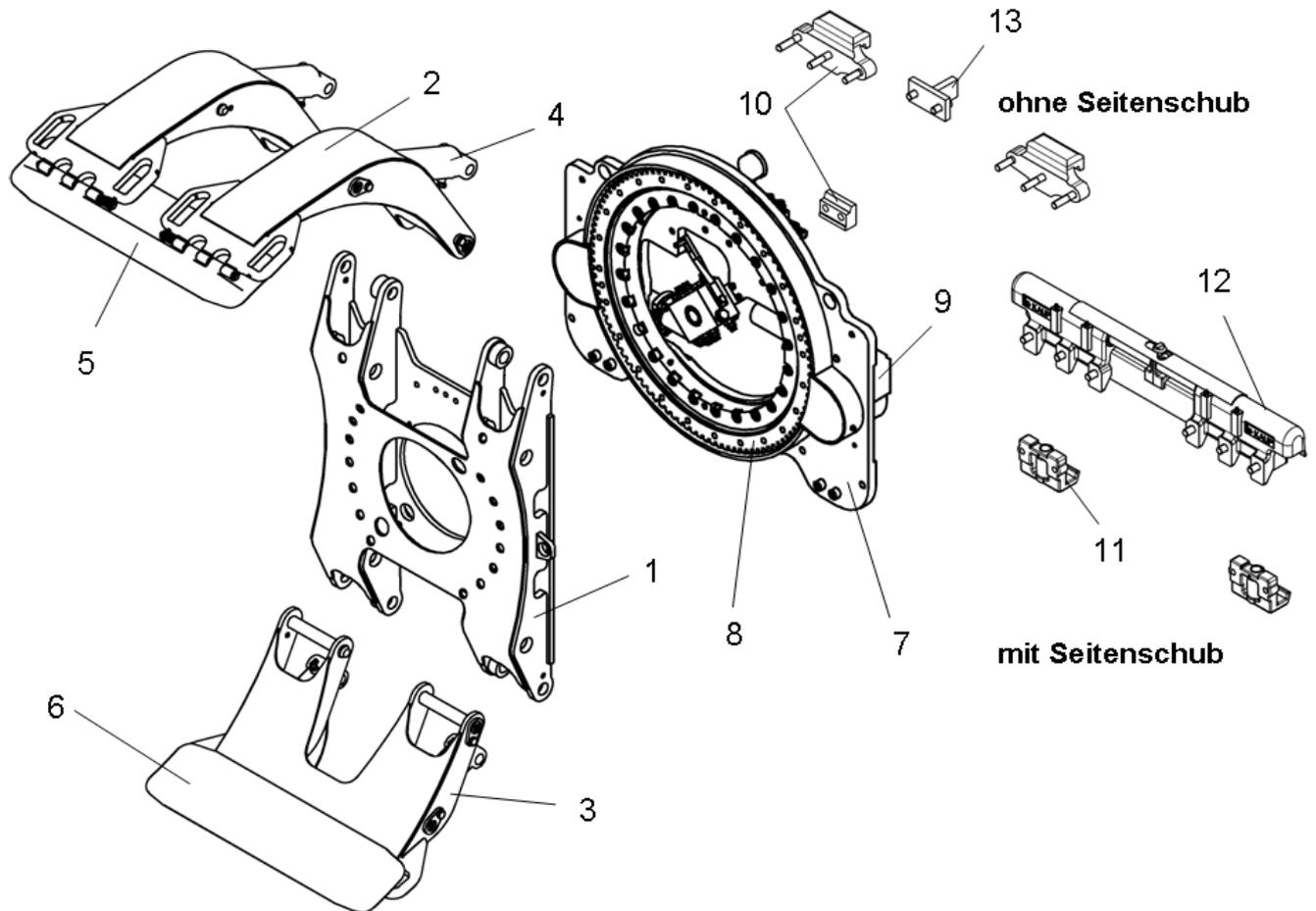
Die Klammer besteht aus einem Klammerkörper (1), einem oberen Arm (2) und einem unteren Arm (3), die mit Hydraulikzylindern (4) verstellt werden. Der obere Arm (2) hat eine durchgehende Druckplatte (5), bei Modell T458/T498, oder eine geteilte Druckplatte, bei Modell T458-2/T498-2.
