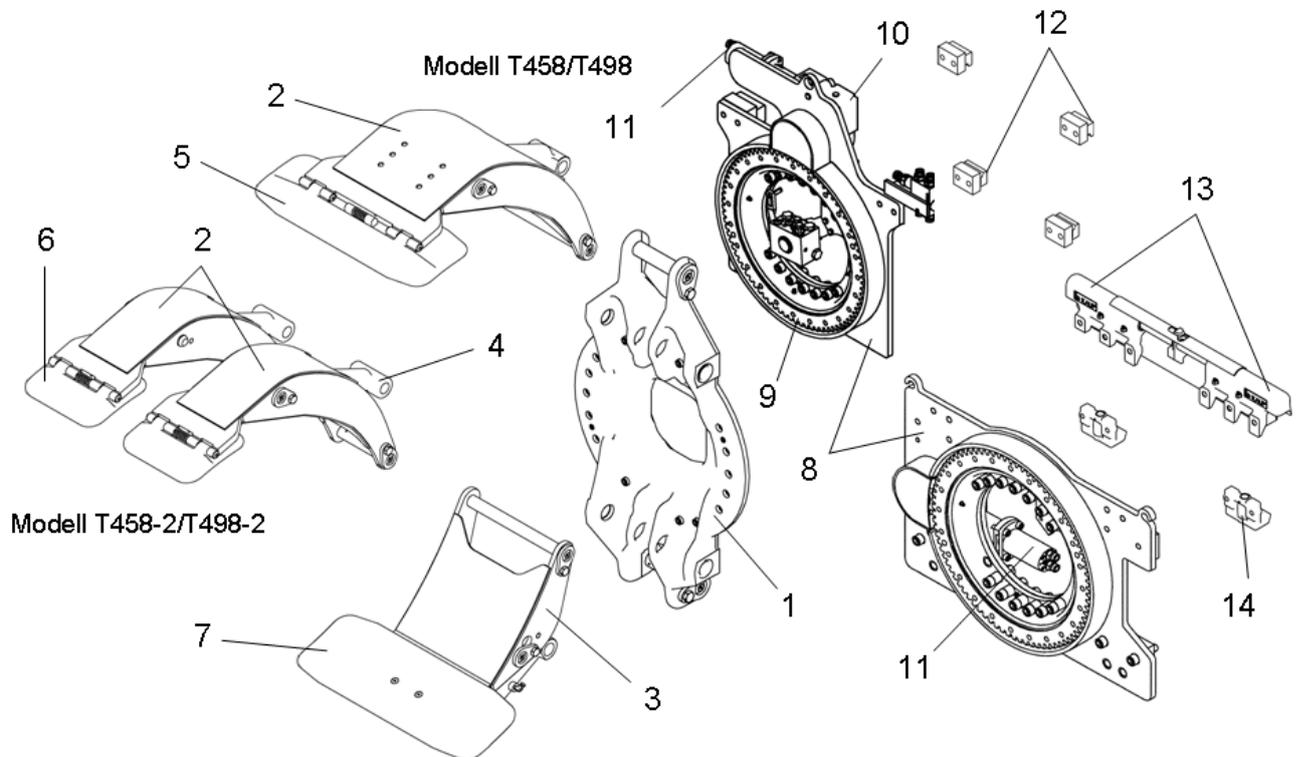
Die Klammer besteht aus einem Klammerkörper (1), einem oberen Arm (2) und einem unteren Arm (3), die mit Hydraulikzylindern (4) verstellt werden.
