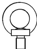
Tragkraft 250 kg/M16
