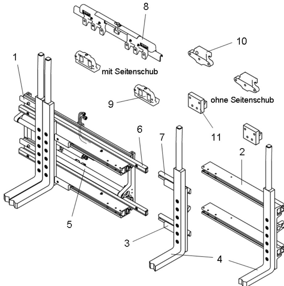
Ein Doppel-Palettengerät besteht aus einem Klammerkörper (1), auf dem äußere Schlitten (2) und innere Schlitten (3) montiert sind. An die Schlitten sind Gabelzinken (4) angeschraubt. Zylinder (5) verschieben die mit Gleitstücken (6, 7) ausgerüsteten Schlitten (2, 3). Am Klammerkörper (1) sind wahlweise Seitenschubkomponenten (8, 9) oder Pratzen (10, 11) angebaut.
