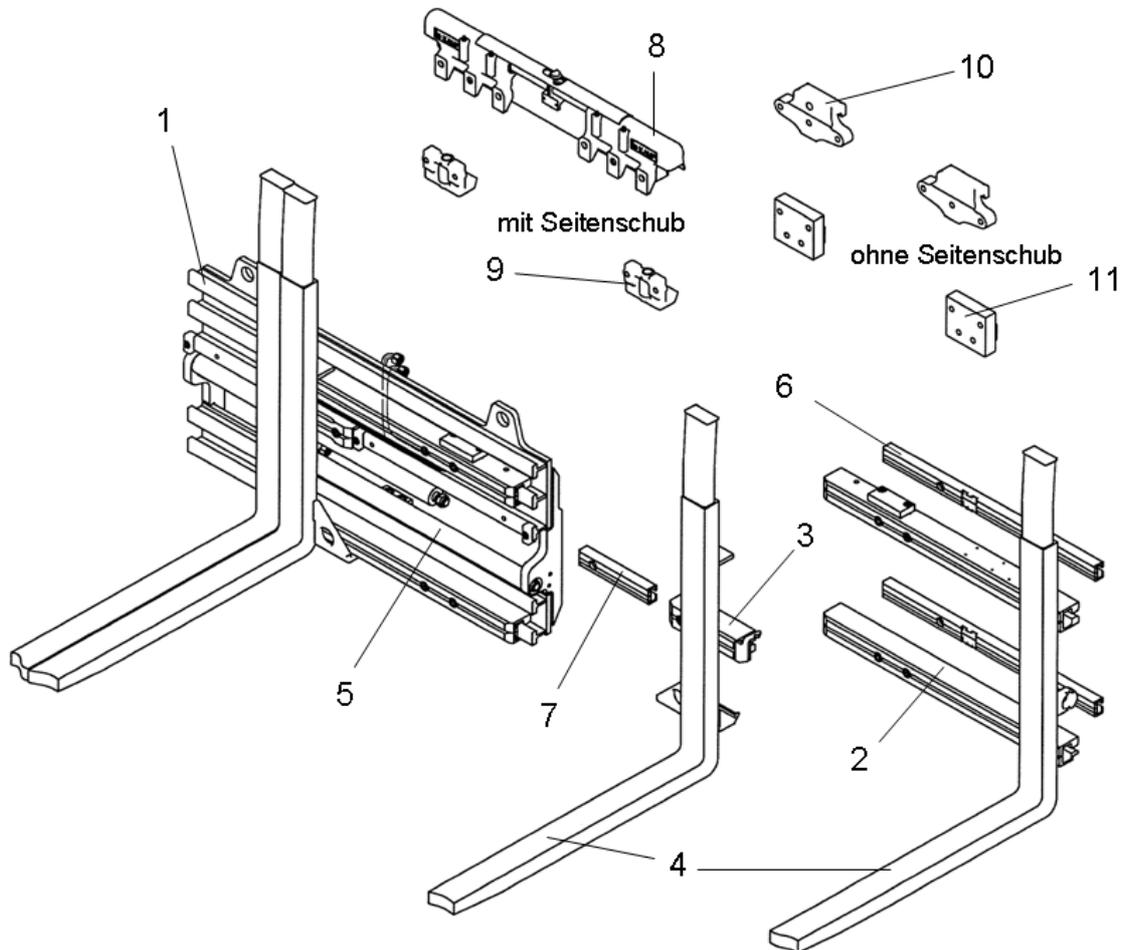
Ein Doppel-Palettengerät besteht aus einem Klammerkörper (1), auf dem äußere Schlitten (2) und innere Schlitten (3) mit Gabeln (4) montiert sind. Zylinder (5) verschieben die mit Gleitstücken (6, 7) ausgerüsteten Schlitten (2, 3). Am Klammerkörper (1) sind wahlweise Seitenschubkomponenten (8, 9) oder Pratzen (10, 11) angebaut.
