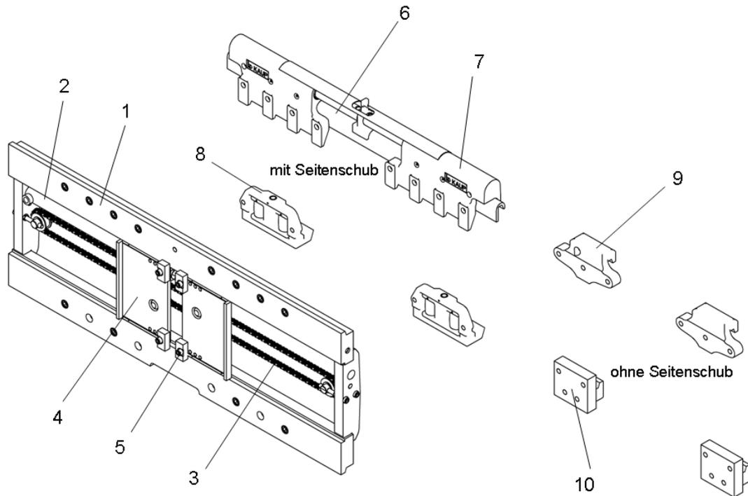
Das Zinkenverstellgerät besteht aus einem Gabelträger (1), in dem über einen Zylinder (2) und Kette (3) eine Mitnahme (4) mit Gabelverliersicherung (5) hydraulisch verschoben wird. Eine Führungsschiene (6), Seitenschubkomponenten (7) und Pratzen (8) werden von der Rückseite an den Gabelträger (1) montiert. Bei der Ausführung ohne Seitenschub werden obere Pratzen (9) und untere Pratzen (10) an den Gabelträger (1) angeschraubt.
