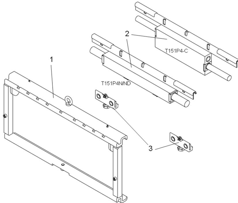
Der Seitenschieber T151 P4 besteht aus einem Gabelträger (1), der zur Aufnahme von Gabelzinken oder Anbaugeräten geeignet ist. Der Gabelträger wird auf einen Plungerzylinder mit integrierter Führungsschiene (2) montiert. Zwei Pratzen mit Gleitprofilen (3) werden im unteren Teil des Gabelträgers (1) arretiert. Am Gabelträger sind Begrenzungen angebracht, die ein seitliches Herabgleiten der Gabelzinken verhindern.
