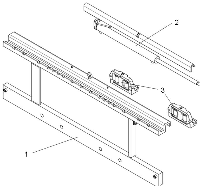
Der Seitenschieber T151 P-C besteht aus einem Gabelträger (1), der zur Aufnahme von Gabelzinken oder Anbaugeräten geeignet ist. Der Gabelträger wird auf eine Führungsschiene mit Zylinder (2) montiert. Zwei Pratzen mit Rollen (3) werden am unteren Teil des Gabelträgers (1) angeschraubt. Am Gabelträger sind Begrenzungen angebracht, die ein seitliches Herabgleiten der Gabelzinken verhindern.
