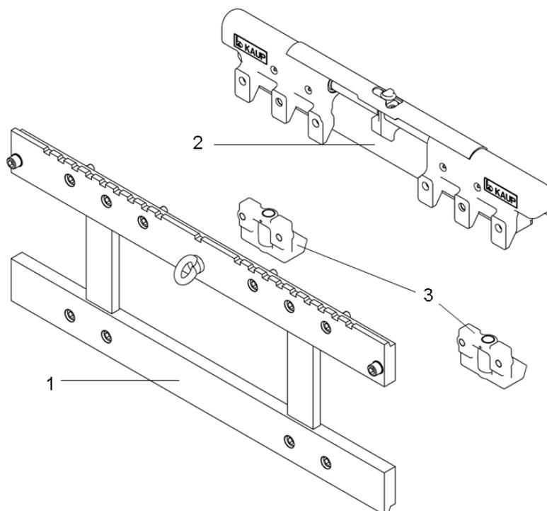
Der Seitenschieber T151 P2 besteht aus einem Gabelträger (1) der zur Aufnahme von Gabelzinken oder Anbaugeräten geeignet ist. An der Rückseite werden Seitenschiebergehäuse mit einer Führungsschiene (2) und Pratzen mit integrierten Rollen (3) an den Gabelträger (1) angeschraubt. Am Gabelträger sind Begrenzungen angebracht, die ein seitliches Herabgleiten der Gabelzinken verhindern.
